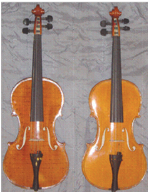
Rys. 5.12. Skrzypce, repliki instrumentu „Ysaÿe” Giuseppe Guarneriego del Gesù (1740), pokryte lakierem spiżusowym – z lewej strony (widoczna siatka pomiarowa testu modalnego), skrzypce pokryte lakierem olejnym z prawej strony
