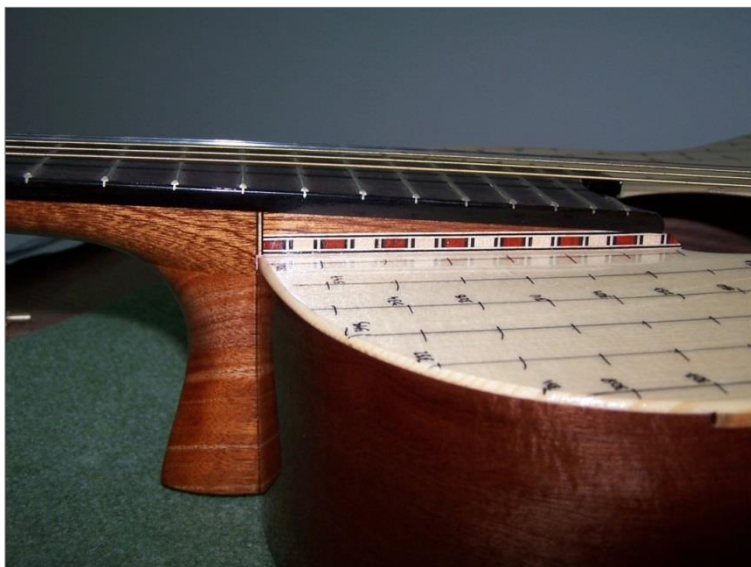
Rys. 4.8. Szyjka gitary zamontowana pod kątem
